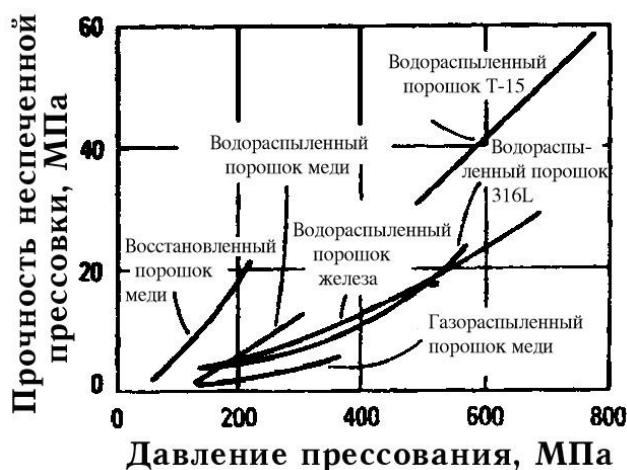
Рис. 3. Прочность неспеченных прессовок в зависимости от способа изготовления порошка
