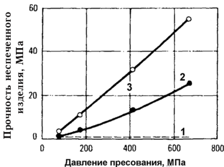
Рис. 4. Влияние размера частиц на прочность неспеченных образцов из электролитического порошка железа после изостатического прессования: 1 – грубый порошок: 100% – 42+100 меш; 2 – средний: 22% – 325 меш, 78% – 65+325 меш; 3 – тонкий порошок: 100% – 325 меш
